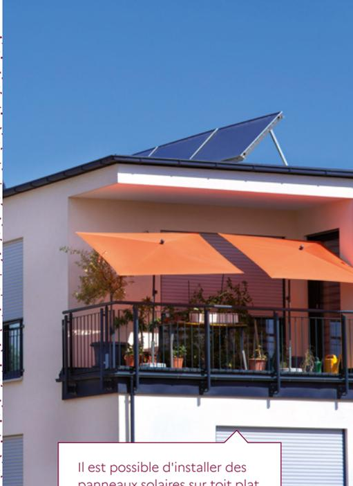
Il est possible d'installer des panneaux solaires sur toit plat, en respectant une inclinaison comprise entre 30 et 60°.
