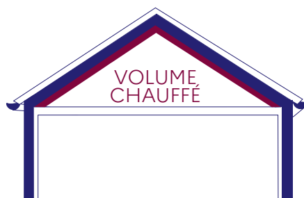
SUR LES RAMPANTS DE LA TOITURE POUR LES COMBLES AMÉNAGÉS
