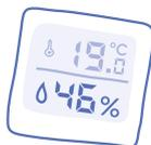
Dans un logement trop humide et mal ventilé, des moisissures peuvent se développer sur les parois (cloques, tâches noires...). Leurs spores, particulièrement néfastes pour les enfants, fragilisent les voies respiratoires et aggravent certaines pathologies. Le taux d'humidité dans le logement doit se situer entre **40 et 60%**. Pour le mesurer équipez-vous d'un hygromètre (souvent couplé avec un thermomètre), disponible à partir de 4€.
