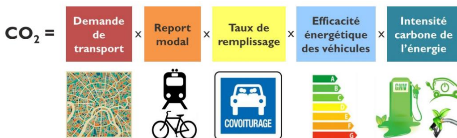
Figure 75 : Leviers clés pour décarboner les transports, utilisés dans la décomposition des émissions (Bigo, 2020)
